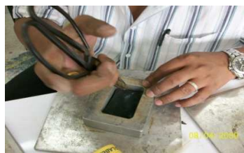
รูป การนำยางดำวางลงไปบนบล็อกโลหะ
