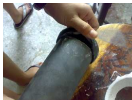
รูป การถอดกรวยและฐานยางออกจากกระบอกรับ
