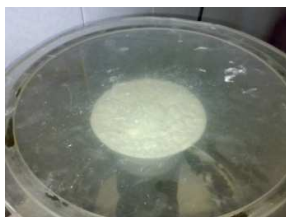
รูป การนำกระบอกรับปูนเข้าเครื่องดูดปูน
