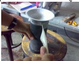
รูป การถอดกรวยและฐานยางออกจากกระบอกรับ
