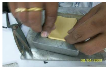
รูป การอัดยางเหลืองและยางดำให้เต็มบล็อกโลหะ
