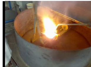
รูป การนำกระบอกลูกออกจากเตาอบและนำมาวางลงในเครื่องเหวี่ยง
