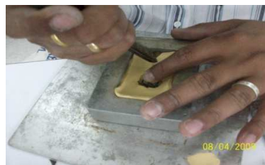
รูป การนำยางเหลืองมาใส่บล็อกและการเอาเศษยางมาอัดตรงรูปแบบ
