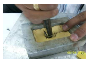
รูป การนำยางเหลืองมาใส่บล็อกและการเอาเศษยางมาอัดตรงรูปแบบ
