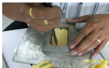
รูป การวางยางเหลืองลงทับบนยางดำ
