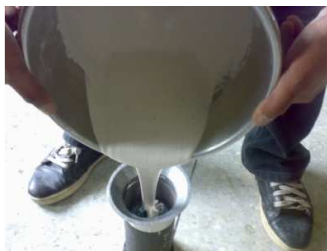
รูป การเทปูนลงในกระบอกรับ
