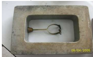
รูป การวางเทียบแม่แบบกับบล็อกอลูมิเนียม
