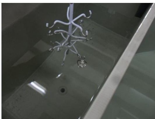
(ภาพที่ ๓๑ นำชิ้นงานมาล้างด้วยน้ำเปล่า 2 ถัง)
