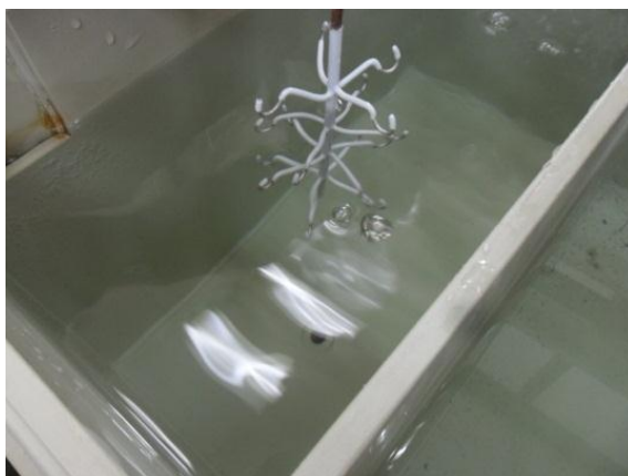
(ภาพที่ ๓๒ นำชิ้นงานมาจุ่มในกรด)
